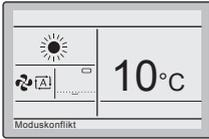
Nur zutreffend bei einem Multisystem (mehrere Innengeräte an das Außengerät angeschlossen). Wenn mehrere Innengeräte simultan betrieben werden, jedoch in verschiedenen Modi, tritt ein Moduskonflikt auf:
