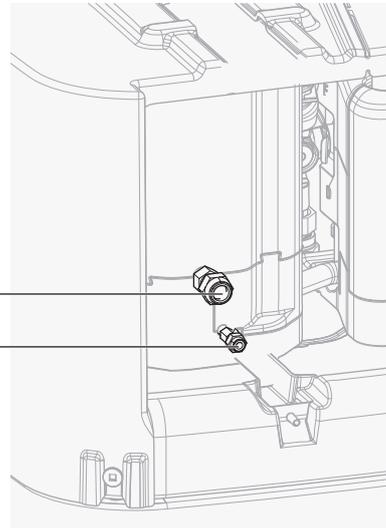
a Anschluss für flüssiges Kältemittel
