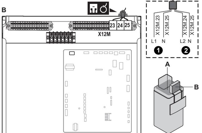
6 Befestigen Sie das Kabel mit Kabelbindern an den Kabelbinderhalterungen. Allgemeine Informationen finden Sie unter "6.3.1 Die elektrischen Leitungen an die Inneneinheiten anschließen" [▶ 22].
