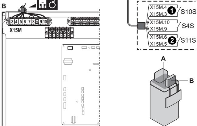
2 Fixieren Sie die Kabel mit Kabelbindern an den Kabelbinderhalterungen.
