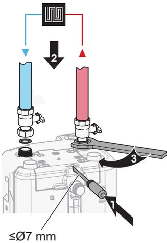
4 Schließen Sie die Wassereinlass- und -auslassrohr für Brauchwasser an das Innengerät an.
