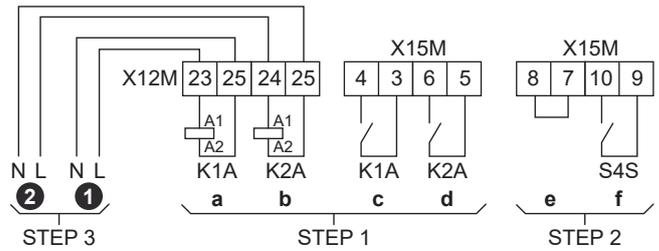
STEP 1 Installation Smart Grid-Relaissatz
