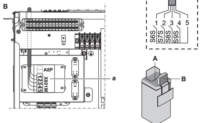
4 Befestigen Sie das Kabel mit Kabelbindern an den Kabelbinderhalterungen. Allgemeine Informationen finden Sie unter "6.3.1 Die elektrischen Leitungen an die Inneneinheiten anschließen" [▶ 22].
