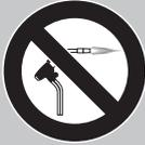
Das abgedrehte Rohrleitungsende NIEMALS durch Löten entfernen.
