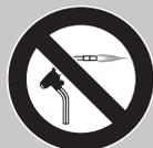
Das abgedrehte Rohrleitungsende NIEMALS durch Löten entfernen.
