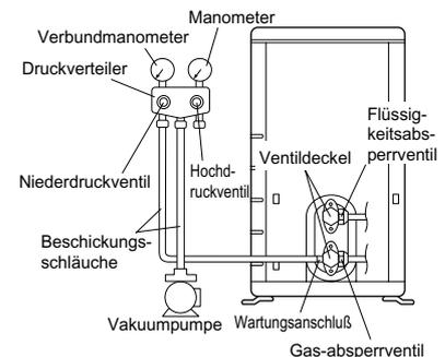
1) Vorstehenden Teil des Befüllschlauchs (angeschlossen am Mehrwegmanometer) an den Serviceanschluss des Gasabsperrentils anschließen.
