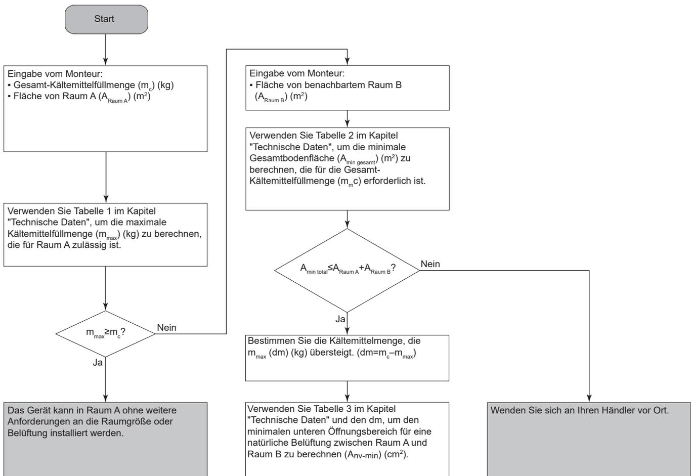
Das Gerät kann in **Raum A** installiert werden, wenn Sie 2 Öffnungen zwischen Raum A und B vorsehen (eine unten und eine oben), um eine natürliche Belüftung sicherzustellen. Die Öffnungen müssen den folgenden Bedingungen entsprechen:
