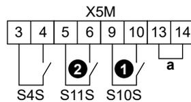
a Drahtbrücke (werkseitig montiert). Wenn Sie auch ein Sicherheitsthermostat (Q4L) anschließen, tauschen Sie die Drahtbrücke gegen die Kabel des Sicherheitsthermostats aus.
