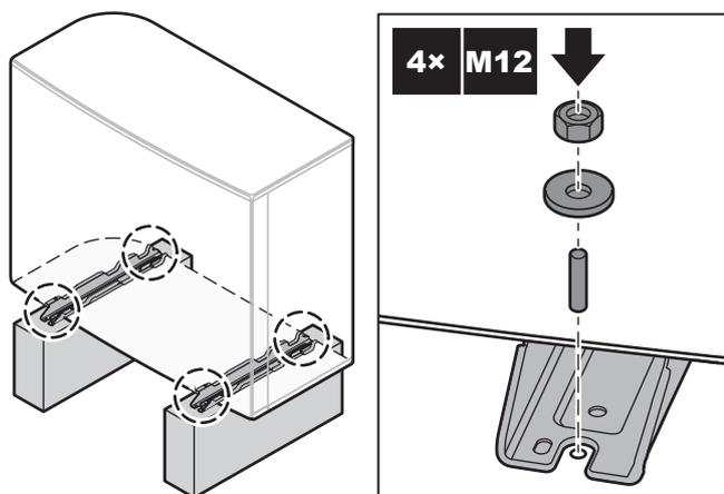
**3** Entfernen Sie die Schlingen (+ Clips + Stifte) und entsorgen Sie sie.
