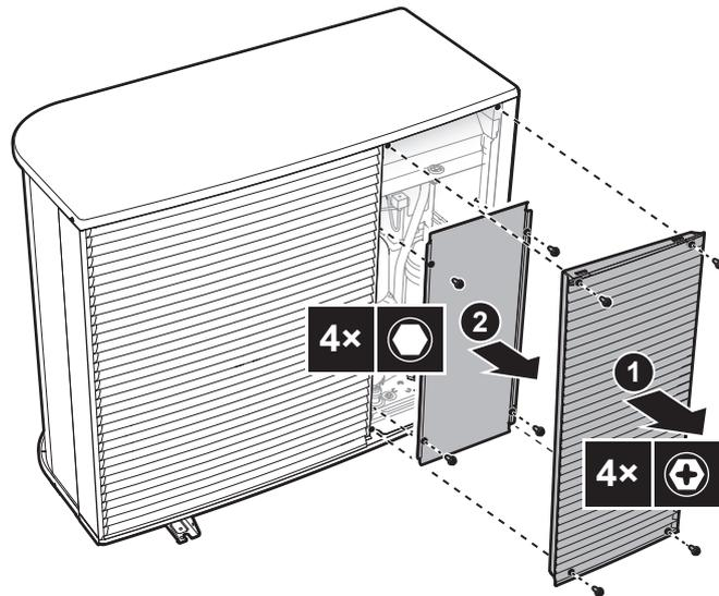
7.2.3 So entfernen Sie die Transportsicherung (Schraube) (+ Unterlegscheibe)
