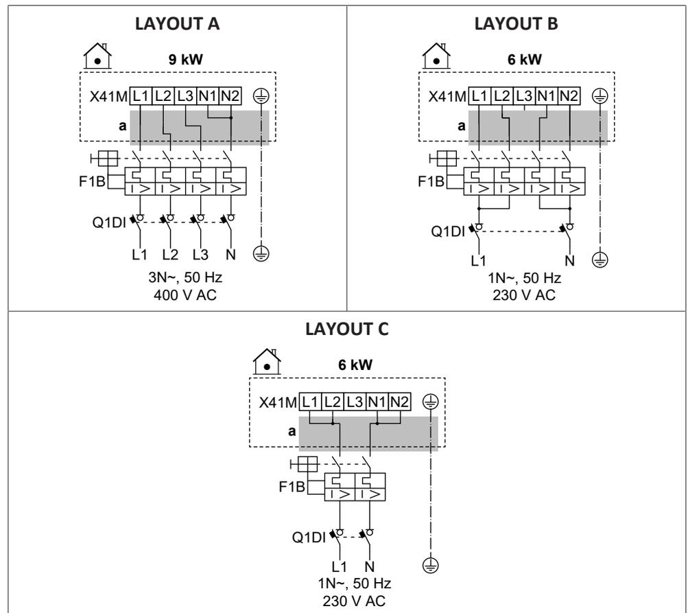
**Mögliche Layouts bei den 4V-Modellen (4,5 kW mehrstufige Reserveheizung)**
