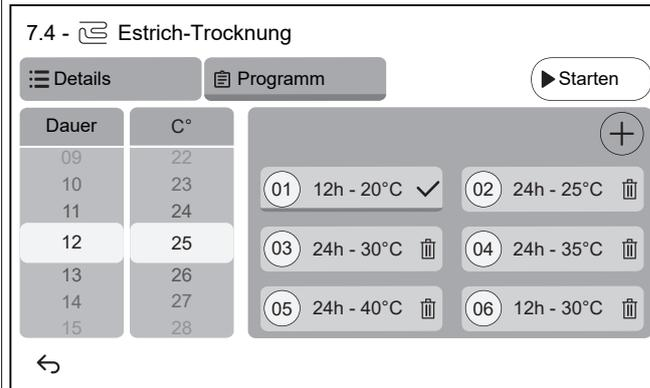
Jeder Programmschritt enthält die Ablaufnummer, die Dauer und die gewünschte Vorlauftemperatur.
