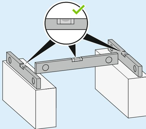
Verwenden Sie 4 Sätze mit M12-Ankerbolzen, Muttern und Unterlegscheiben. Lassen Sie mindestens 150 mm Freiraum unter dem Gerät. Stellen Sie zusätzlich sicher, dass das Gerät mindestens 100 mm über der maximal zu erwartenden Schneehöhe positioniert ist.
