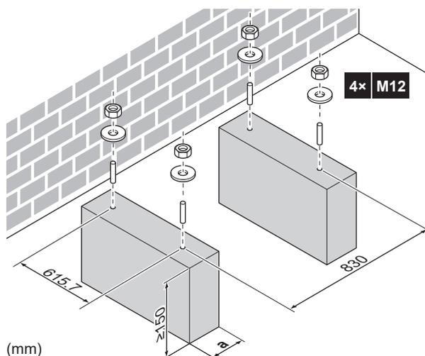
a Stellen Sie sicher, dass Sie nicht das Abflussloch in der Bodenplatte des Geräts bedecken.
