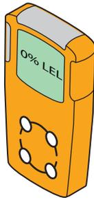
Ein UEG-Detektor misst, ob ein Brennstoff (z. B. R290) vorhanden ist und welche Menge in der Luft vorhanden ist (Vol.-%). Wenn das Gemisch zwischen UEG und OEG liegt und ein Funke entsteht, kann es zu einer Explosion kommen.
