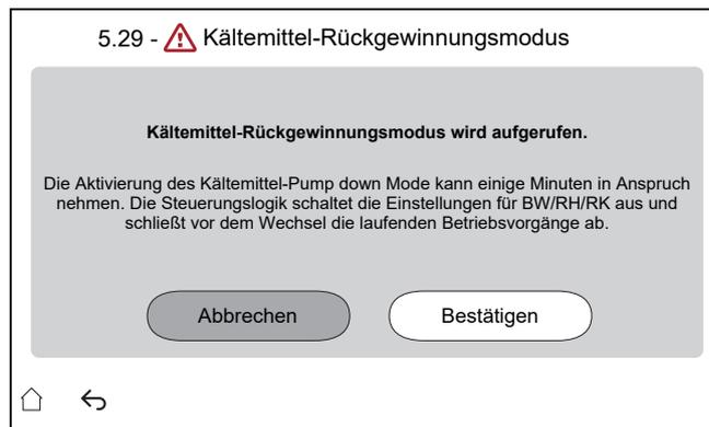
**Ergebnis:** Das Gerät bereitet sich darauf vor, **Kältemittel-Rückgewinnungsmodus** aufzurufen. Dies kann ein paar Minuten dauern. Um den Monteur zu informieren, erscheint der folgende Bildschirm:
