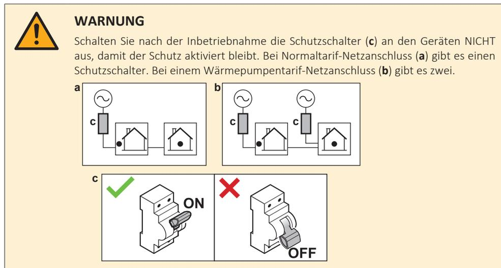
Bringen Sie zur Warnung des Benutzers die Aufkleber "Schutzschalter NICHT AUSSCHALTEN" im Schaltschrank und so nah wie möglich an den Schutzschaltern der Wärmepumpe an. Tragen Sie für größtmögliche Klarheit die Referenznummer des Schutzschalters auf dem Aufkleber ein.
