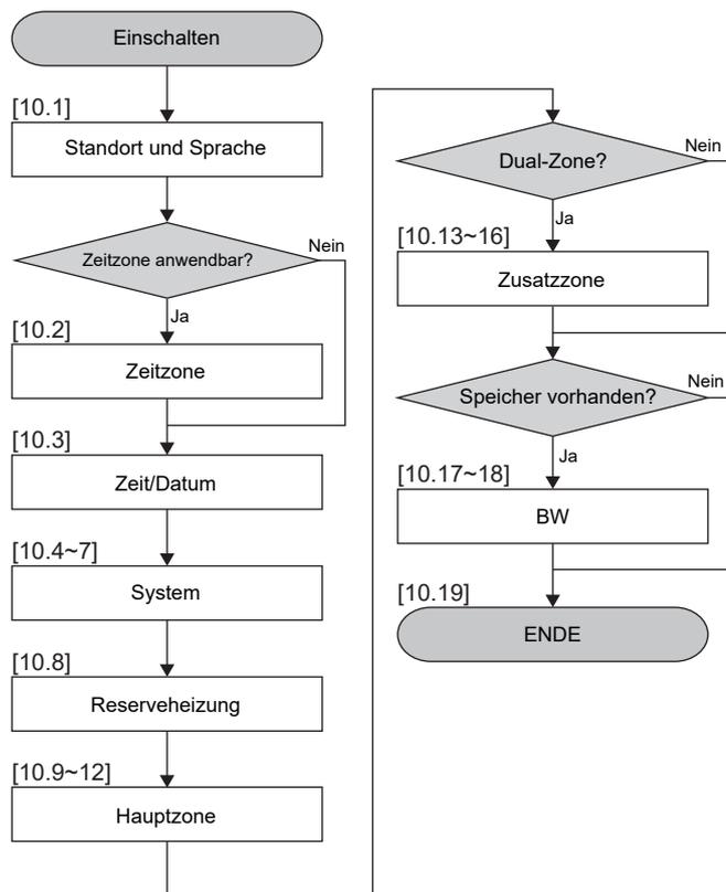
Nachdem Sie alle Schritte des Assistenten ausgeführt haben, zeigt das Raumbedienmodul eine Fehlermeldung an, in der Sie aufgefordert werden, Digital Key einzugeben (d. h. den Entsperrungsvorgang durchzuführen). Siehe "[11.4.1 So entriegeln Sie das Außengerät \(Verdichter\)](#)" [▶ 157].
