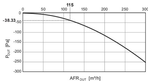
Um den Druckabfall zu ermitteln, der von allen Komponenten im Kanalsystem erzeugt wird, benutzen Sie die Kurven des Komponenten-Herstellers mit den jeweiligen Erläuterungen. Möglicherweise ist eine Umrechnung der Einheiten erforderlich. Beachten Sie, dass der Hersteller den Druckabfall für Kanäle möglicherweise pro Längeneinheit der Kanäle angibt (Einheiten sind z. B. Pa/m). Um den Gesamtdruckabfall zu ermitteln, multiplizieren Sie diesen Wert mit der Kanallänge.
