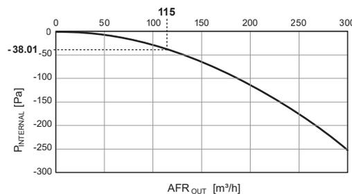
**Hinweis:** Diese Kurven stellen den Innendruck der SV-Einheit im Vergleich zu einem Umgebungsdruck von 101325 Pa dar.
