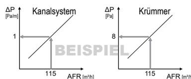
Notieren Sie den Druckabfall der einzelnen Komponenten in einer Übersichtstabelle. Addieren Sie die Druckverluste.
