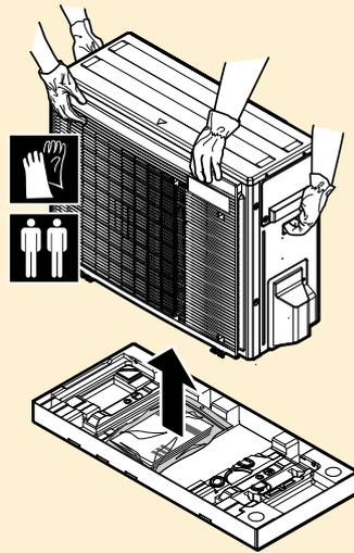
**Installation der Einheit (siehe "6 Installation des Geräts" [▶ 25])**
