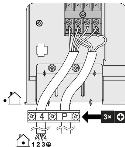
6 Ziehen Sie die Klemmschrauben fest an. Wir empfehlen die Verwendung eines Kreuzschlitzschraubendrehers.
