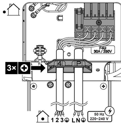
**5** Ziehen Sie die Klemmschrauben fest an. Wir empfehlen die Verwendung eines Kreuzschlitzschraubendrehers.
