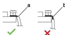
a Entfernen Sie die Kabelisolierung bis zu diesem Punkt
