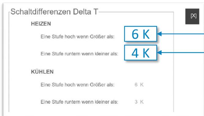
Stufenerhöhung bei 6 K
